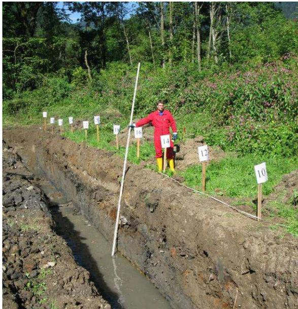
Unter Zuhilfenahme von Maßband und Meßlatte wurde der Aufbau der einzelnen Schürfe protokolliert und ist auf den folgenden sieben Seiten dargestellt. Aus interessierenden Bereichen wurden Feststoff- und Wasserproben entnommen; die räumliche Lage der
