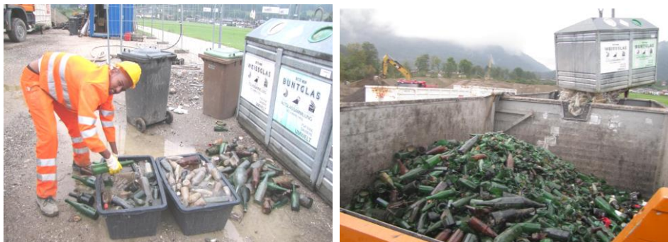
Abb. 39: Manuelle Reinigung und Farbsortierung von Behälterglas (links), rechts: Verladung in einen LKW mit getrenntem Aufbau (im Moment der Aufnahme wird der Teilbehälter für Weißglas entleert)
