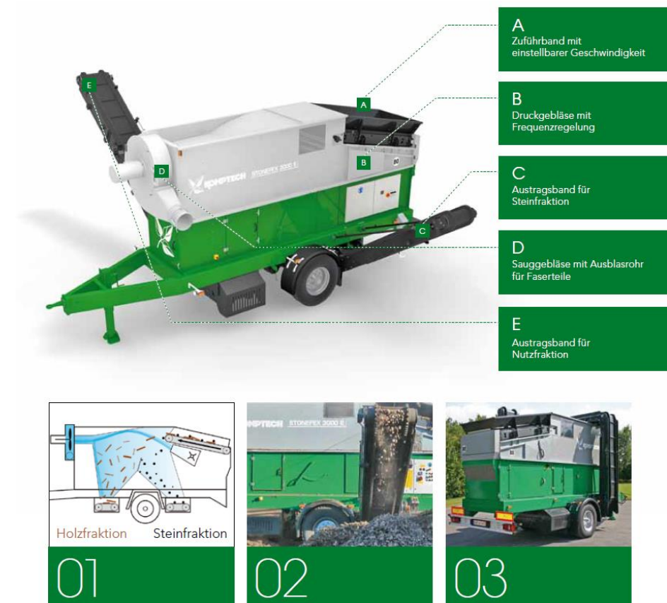
Abb. 23: Mobiler Windsichter Fabrikat KOMPTECH Typ STONEFEX
