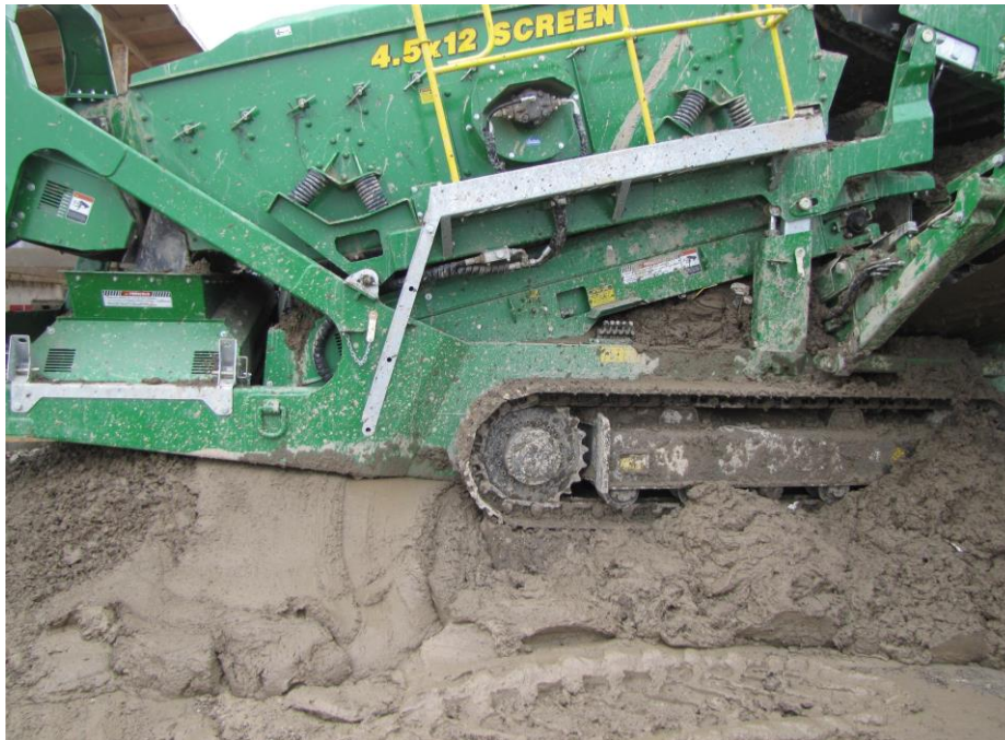
Abb. 27: Sieb bei Verarbeitung von nassem Mittelkorn (25. Feber 2015)
