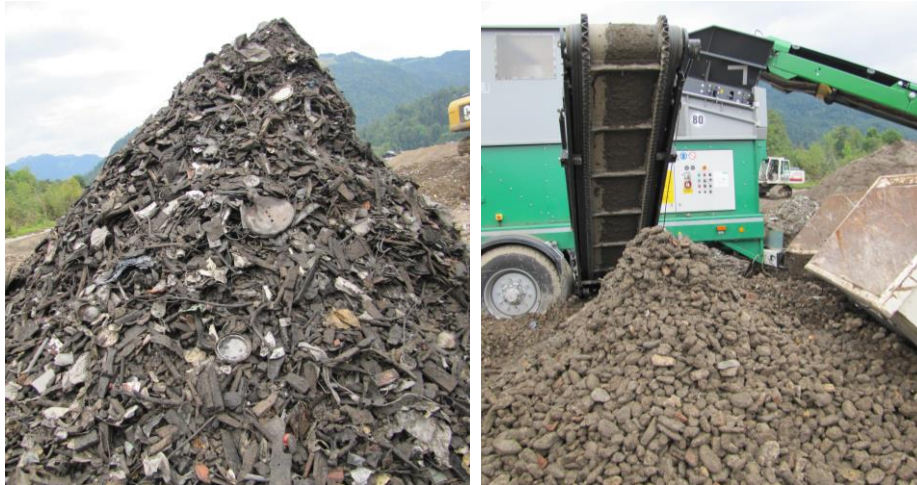
Abb. 24: Vom Windsichter abgeschiedene Anteile 16 (links), „gereinigtes“ Mittelkorn aus einer Schicht mit hohem Müllanteil (rechts)
