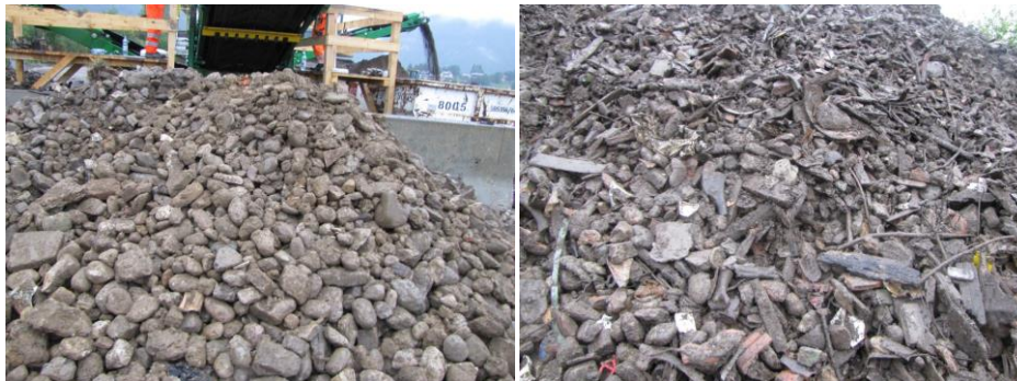
Abb. 22: Kaum verunreinigtes Mittelkorn aus einer oberen (links), stark verunreinigtes Mittelkorn aus einer unteren Aushubschicht
