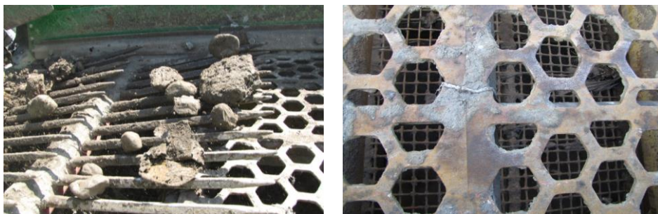
Abb. 18: Details des zur Materialtrennung eingesetzten Doppeldecker-Rüttelsiebs: Einlauf mit „Fingern“ zur Vergleichmäßigung des Materialstroms (links), Siebdecks \varnothing 70 und 40 mm (rechts)
