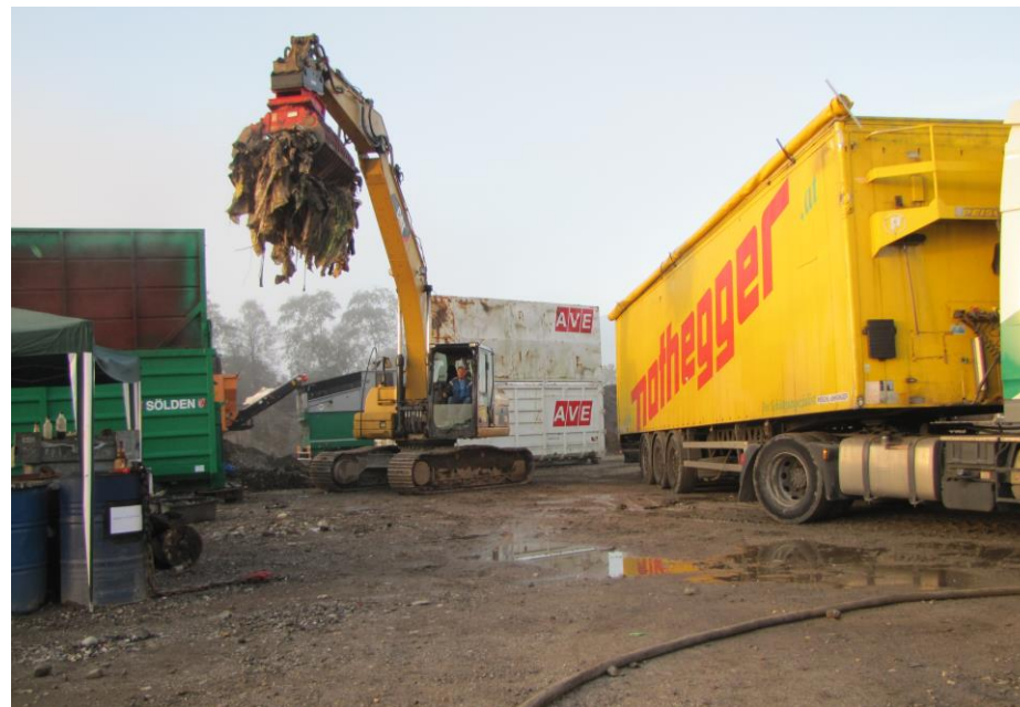
Abb. 42: Verladung von Restmüll aus gedecktem Lagercontainer (links) in LKW mit Schubbodenaufbau („Walking Floor“) 90 m 3
