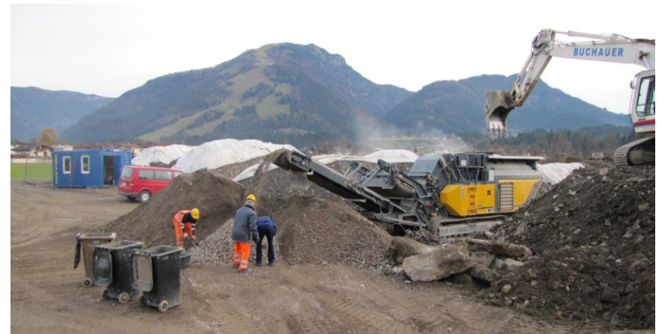
Abb. 21: Versuchsweise Zerkleinerung von „Überkorn“ mit händischer Störstoffkontrolle (17. November 2014)
