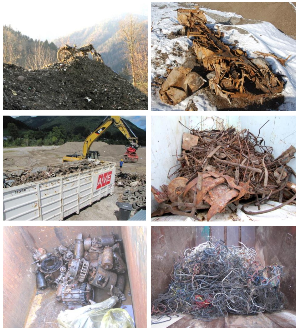
Abb. 36: Von links oben im Uhrzeigersinn: Wracks eines Motorrads (eine Horex Regina, Baujahr um 1955) und Postautos (Foto: H. Brinkmann) als Beispiele für Eisenschrott Sorte E 1, Eisenschrott Sorte E 3, Kupferkabel isoliert, Elektromotoren und im 38 m 3 -Abrollcontainer verladener Eisenschrott E 1.
